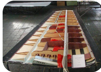
Fehlerhafte Blindverklebung einer Rippe in einer Leichtflugzeug-Tragfläche
